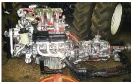
Разрез двигателя и коробки передач автомобиля «Форд».
